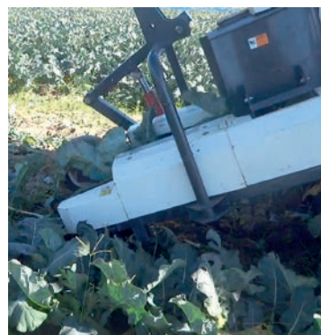
【機械ブロッコリー機械収穫機】
