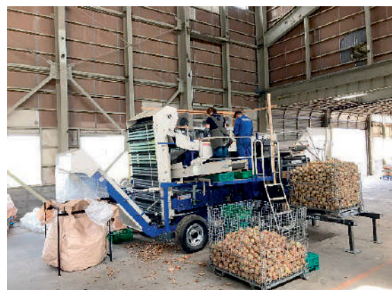
タッピングセレクトによる根葉切り・選別
