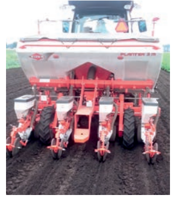
バキュームが強すぎると 種子コートを破損させ発芽 不良を起こすか
