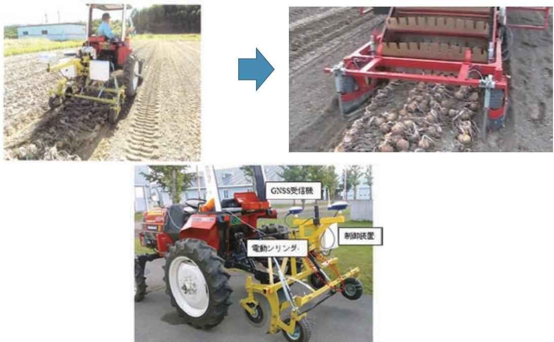
図11 収穫前根切り作業での機械調整の自動化
