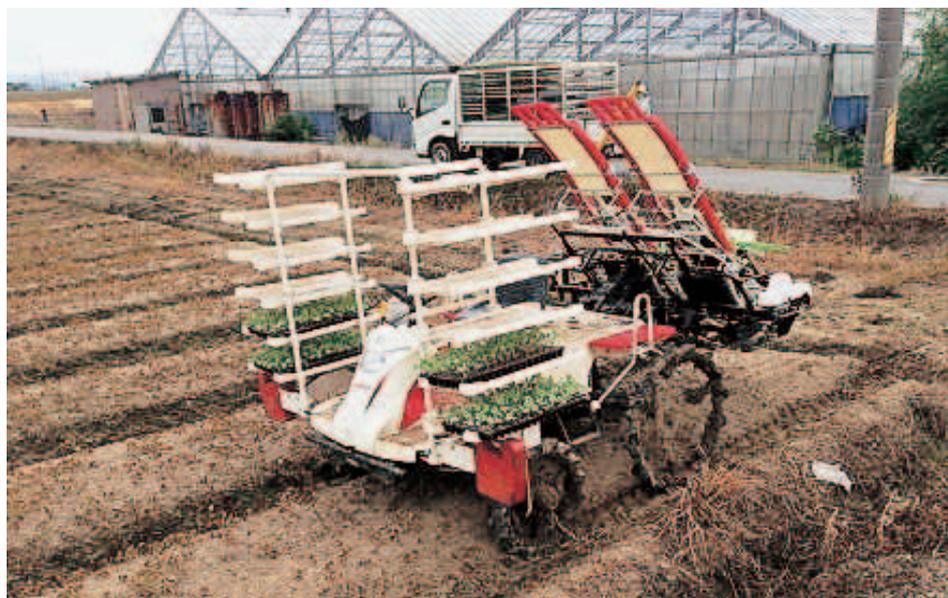
図47 乗用型全自動野菜移植機(1畝2条定植)
