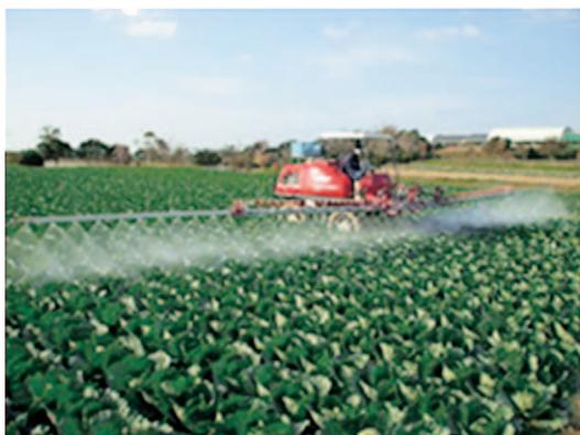
図 49 ブームスプレーヤーによる散布
