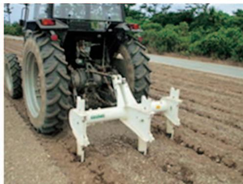
図 37 サブソイラーによる耕耘状況
